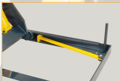
Barra de seguridad para mantenimiento Safety bar for maintenance
